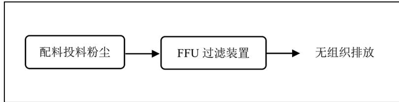
图 3-1 项目配料投料粉尘处理工艺流程图
